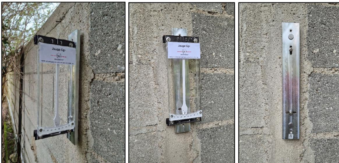
La jauge G5+ est un **inclinomètre amovible** destiné à mesurer l'évolution d'une inclinaison ou d'un basculement.
