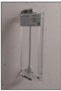
La jauge G5 est un inclinomètre destiné à mesurer l'évolution d'une inclinaison ou d'un basculement (mur, balcon, tablier, porte-à-faux, ...)
