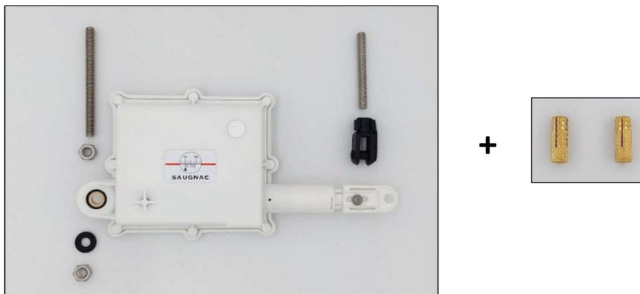
L'installation ne nécessite que le perçage de deux trous de  $\varnothing 8$  mm et de 30 mm de profondeur. L'ensemble des étapes est décrit de façon détaillée avec des photos dans la notice fournie.
