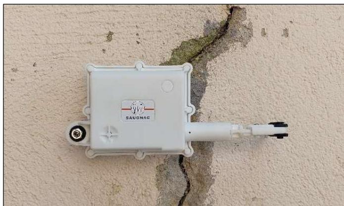
La jauge R1 est un fissuromètre connecté avec 3 capteurs de mesures :
