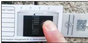
La jauge G1+ est recommandée pour le suivi de l'écartement de fissures. Elle permet de réaliser des mesures fiables avec 0,05 mm de résolution.
