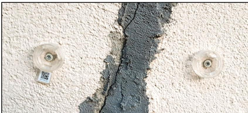
La jauge E1 est recommandée pour le suivi des fissures sur 1 axe (écartement) ou sur 2 axes (écartement + cisaillement).
