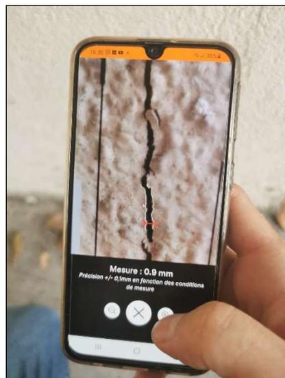
Le fissuromètre « augmenté » est une règle transparente qui permet de **mesurer la largeur d'une fissure**. L'innovation de cette nouvelle version du fissuromètre est de permettre de réaliser la mesure de la largeur de 2 façons :
