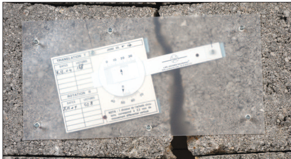
Fixation de la jauge G6 et de sa protection par tap-vis
