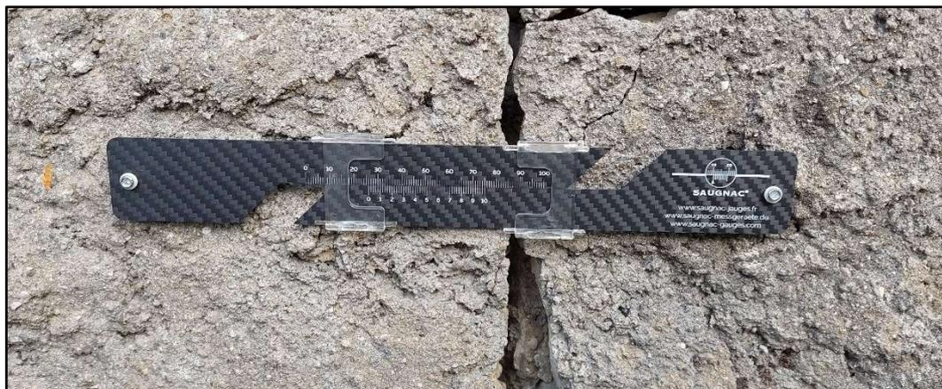
La jauge G1.5 est un instrument de précision conçu pour le suivi et la surveillance de l'écartement des fissures. Elle se distingue par sa **conception en carbone** et une **résolution de 0,02 mm**.
